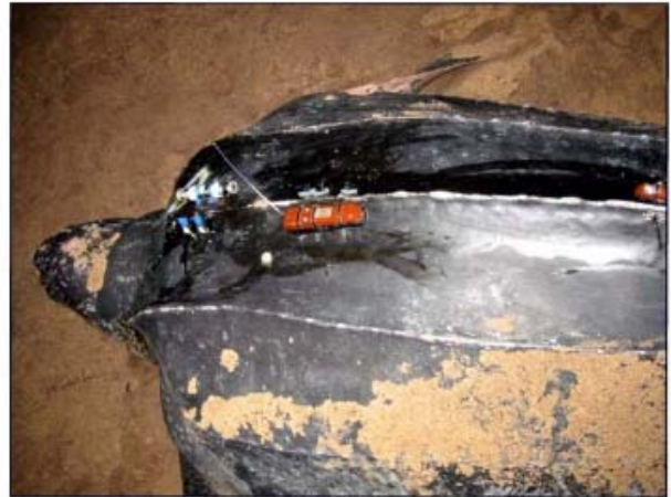
Figure 7-7. Direct carapace attachment on leatherback (Photo courtesy of Sandra Ferraroli, Centre National de la Recherche Scientifique).
